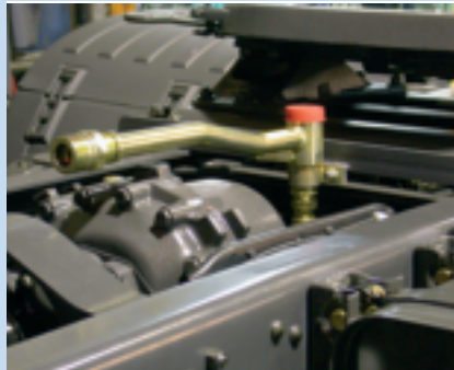
Der neue Sonder-Hydraulikschwenkarm von Launhardt in gekröpfter Ausführung für Sattelzugmaschinen
